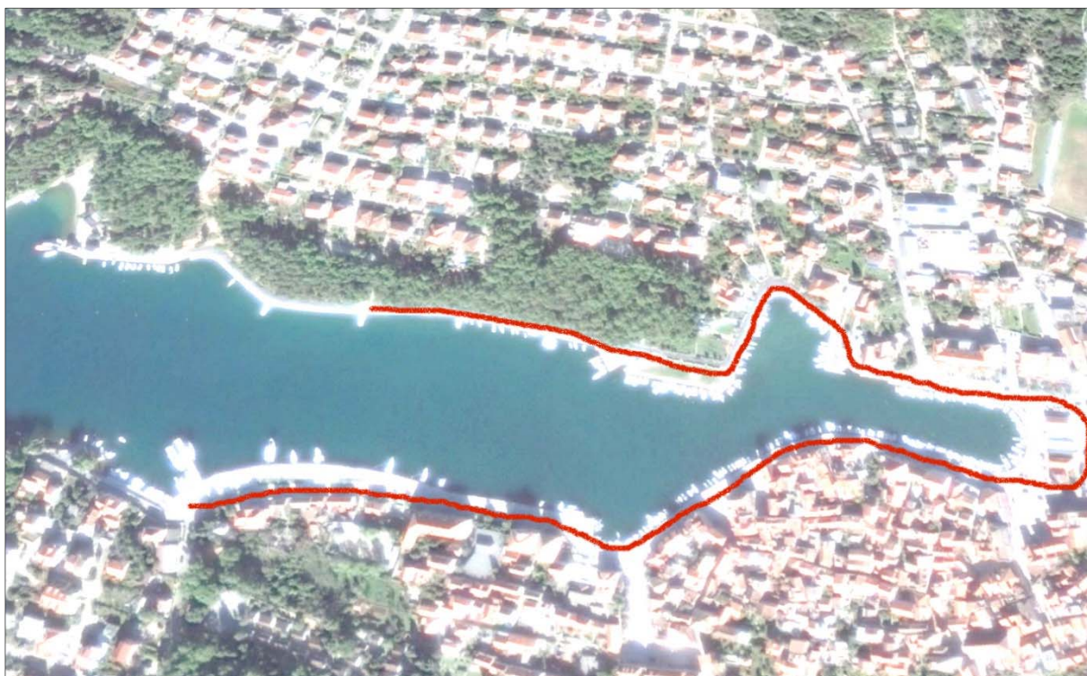
Slika 43: Trase cijevi u vlasništvu poduzeća Hvarski vodovod d.o.o. na području Grada Starog Grada.
